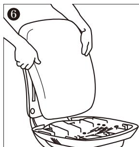
背面上面部は背面を下へ押さえ込みながら、背面受けのツメからA～Cのクリップを外す。
