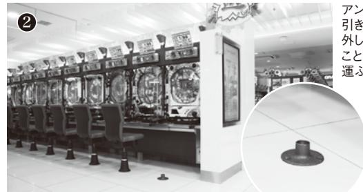
再度、椅子をアンカーベースに取付ける時は、シート部(ポールが付いた状態)を持ち、アンカーベースにポールを差し込む。その際、アンカーベースにポールがきちんとはまるように押し込んでください。
