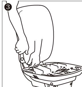
座面後方のウレタン部分と座面受け部分の隙間から座面を持ち上げI～Kのクリップを外す。
