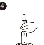
ポール先端の溝が遊技台と平行にならしL字ビンに差し込む。
