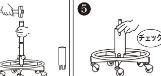
キャスターにボールを差しこみ、ボールたき(P1)をボールのシャフトにかぶせてハンマーでたたく。
