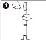
ボールたたき(P1)をボールのシャフトにかぶせてハンマーでたたく。
