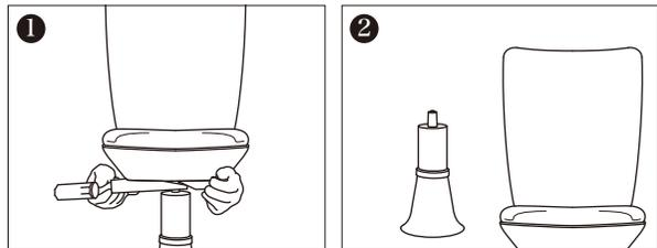
シートとボールの間に取外しジグ(M1)を取外したシートを安全な場所に置いてと(M2)を交互に差し込み、ハンマーでたたいてシートを取外す。
