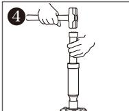
ボールたたき(P2)をボールのシャフトにかぶせてハンマーでたたく。
