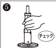
L字ピンを差し込みにセットし、ボールが抜けにくいことを確認して完了。
