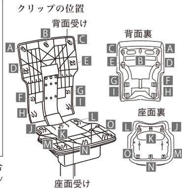
※クリップをはめ込む時は、クリップ位置を確認して下さい。無理なはめ込みは、クリップの破損の原因にもなります。
