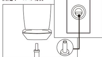
シート部裏面に内蔵されたスライド側受け口のT字バーに、ボール先端の切り込み(溝)が完全にはまるように上からシートを押し込みます。
