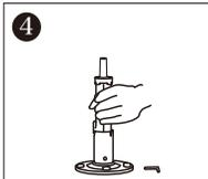
ボール先端の溝を遊技台と平行にしながらU字の切込みにはまるようにボールを差し込む。
