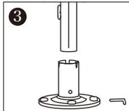
アンカーベースU字の切込部とボール側突起が合う位置を確認。
