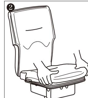
続いて座面先端部の左右を持ち上げてM~Oのクリップを外し、座面の取外しが完了。
