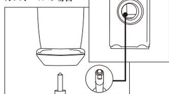
シート部裏面に内蔵されたスライド側受け口にボール先端部のDカット部が完全にはまるように上からシートを押し込みます。
