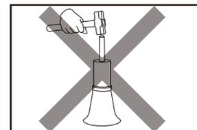
アンカーベースのボルトを絞めたり緩めたりするとボルトが折れ破損し、転倒の原因にもなり大変危険です。ベースの歪みやボルトの緩みを発見したら放置せず、すぐに販売店またはエルゴジャパンまでご連絡ください。そのまま使用し続けるとケガや故障の原因となります。
