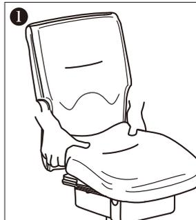
座面後方のウレタン部分と座受け部分の隙間から座面を持ち上げ、上に引きあげて、J~Lのクリップを外す。
