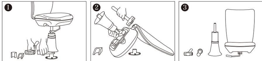
脚部カバーを上げてアンカーベースとボールの間に取外しジグ(M4)を差し込みハンマーでたたく。
