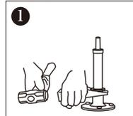
アンカーベースとボールのリングとの間に取外しジグ(M4)を差し込み、ハンマーでたたく。
