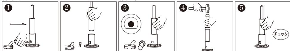
1 アンカーネックの■部分にタガネを差し込み、ハンマーでたたく。
