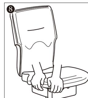
座面受けと座面のクリップ位置を合わせて先端から順番に、J~Oのクリップを押さながらはめ込む。
