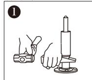
アンカーベースとボールの間に取外しジグ(M4)を差し込み、ハンマーでたたく。
