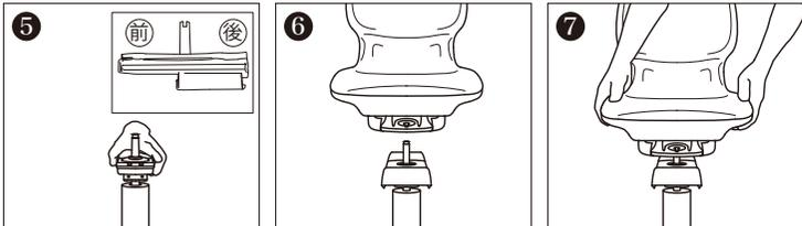
スライド側受け口のT字バーにボール先端の切り込み(溝)をはめ込む。(前)が遊技台側になるように)
