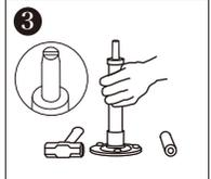
アンカーベースにボールを差し込む。※ボール先端の溝が遊技台と平行になるようにセット。
