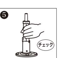
L字ピンを差込口にセットし、ボールが抜けなことを確認して完了。
