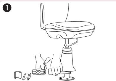
脚部カバーを上げてアンカーベースとポールの間に取外しジグ(M4)を差し込みハンマーでたたく。
